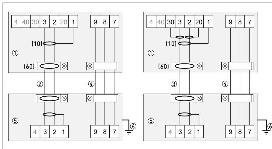
Рисунок 4-5: Схема подключения первичного преобразователя полевого исполнения
