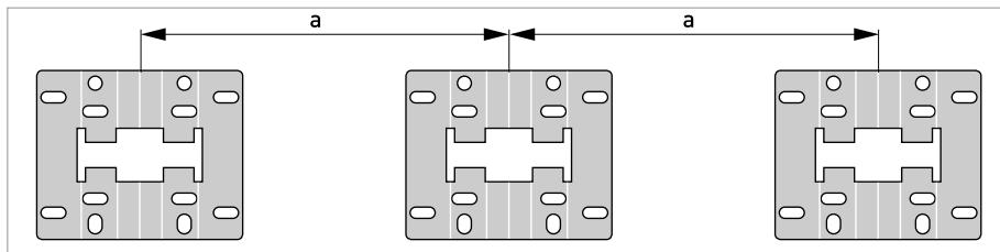
Рисунок 3-6: Монтаж нескольких приборов рядом друг с другом
