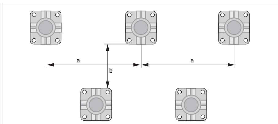
Рисунок 3-3: Монтаж нескольких приборов рядом друг с другом
