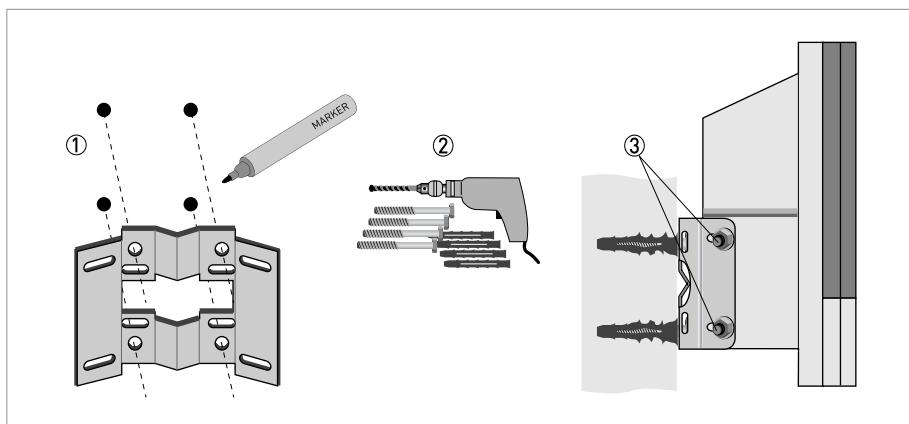
Рисунок 3-5: Крепление корпуса преобразователя сигналов для настенного монтажа
