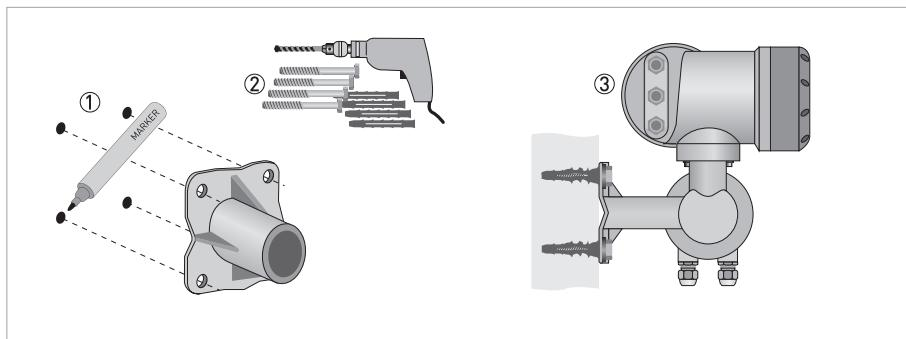
Рисунок 3-2: Крепление полевой версии корпуса на стене
