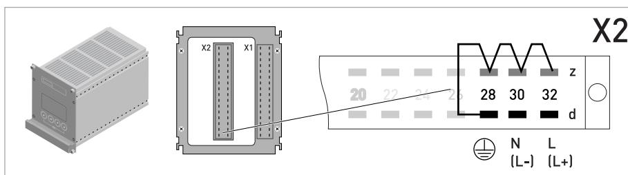
Рисунок 4-11: Подключение питания для корпуса для монтажа в стойку 19" (21 TE)
