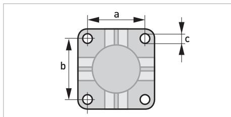
Рисунок 2-2: Размеры монтажной пластины корпуса полевого исполнения
