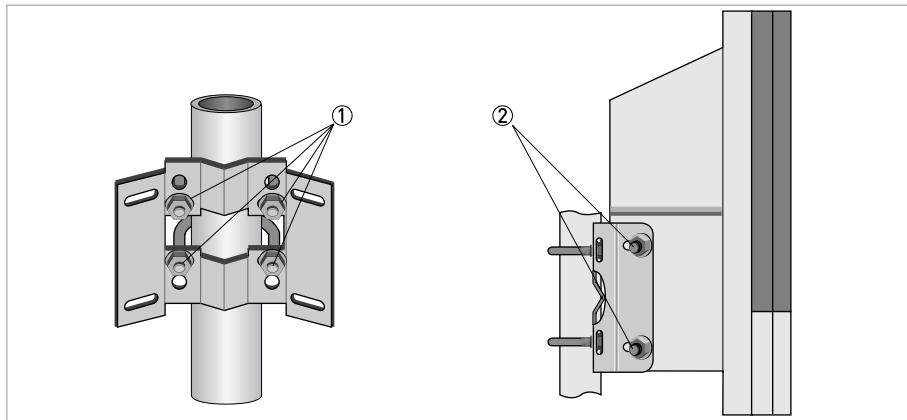
Рисунок 3-4: Крепление преобразователя сигналов для настенного монтажа на стойке
