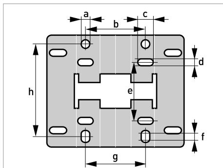
Рисунок 2-3: Размеры монтажной пластины корпуса для настенного монтажа
